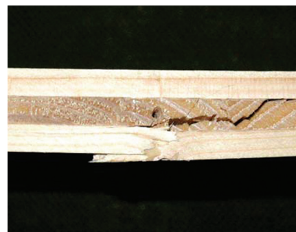
Slika 2. Lom troslojnog CLTa prilikom savijanja
