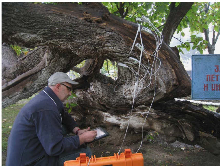
Slika 2. Gospodin Bodo Siegert meri ultrazvučnim tomograфом stanje debla Šam duda u oktobru 2011. godine (Foto: Glavendekić)
