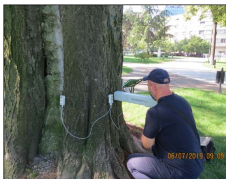
Slika 4. Rezistografija stabla br. 1 između senzora br. 3 i 4 (foto M.Glavenekić)
